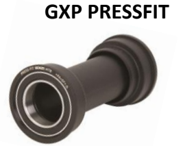
BB GXP CUPS til PRESSFIT Ramme bredde Race 86,5 mm Ramme bredde MTB 92, 104,5, 121 mm Box \varnothing 41 mm Lejer 36x24x7 mm
